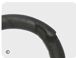
VERDREHTER O-RING JOINT TORIQUE TORDU
