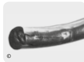
SCHADENSBIELD EINER EXPLOSIVEN ÜBERHITZUNG EXEMPLES D'UNE SURCHAUFFE EXPLOSIVE
