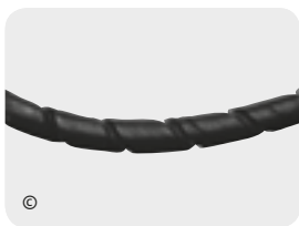
VERDREHTER O-RING JOINT TORIQUE TORDU
