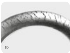
SCHADENSBLD EINER HOHEN OZONBELASTUNG FISSURES CAUSÉES PAR L'OZONE
