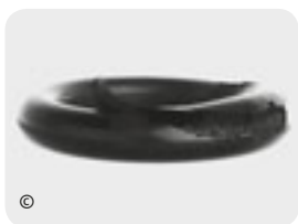
SCHADENSBIKD EINER SPALTEXTRUSION DOMMAGE PAR EXTRUSION DE FISSION
