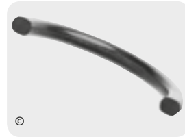
SCHADENSBIELD DURCH HOHE BLEIBENDE VERFORMUNG
