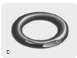
BESCHÄDIGUNG DURCH SCHARFE KANTEN ENDOMMAGEMENT PAR ARÊTE VIF
