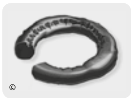
CHEMISCHE ZERSETZUNG EINES O-RINGES DÉCOMPOSITION CHIMIQUE D'UN JOINT TORIQUE
