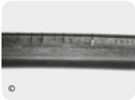
SCHADENSBIELD EINES KURZZEITIG ÜBERHITZTEN O-RINGES
