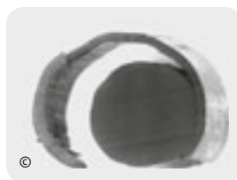
SCHADENSBIKD EINER SPALTEXTRUSION DOMMAGE PAR EXTRUSION DE FISSION
